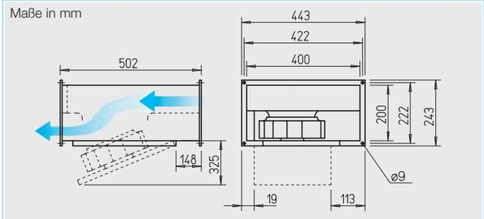
Radial EC-Kanalventilatoren mit rückwärts gekrümmten Laufradschaufeln. Motor-Laufradeinheit ausschwenkbar.
